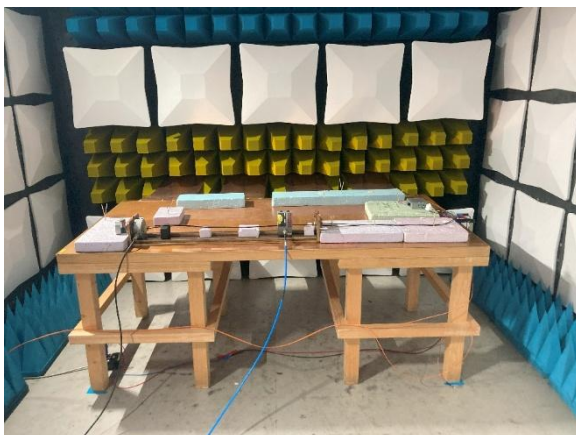
Abbildung 39 Beispiel Prüfaufbau BCI EUT Kameraeinheit (Serializer)
