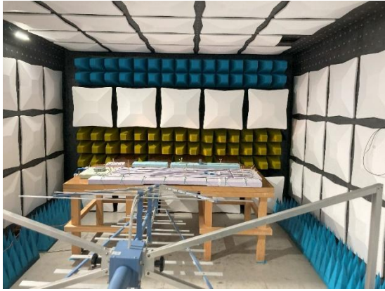
Abbildung 30 Beispiel ALSE-Prüfaufbau mit 1,9 m und 14 m Leitung und LogPer-Antenne
