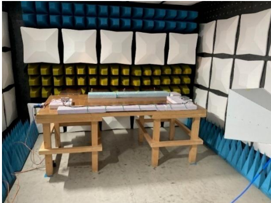
Abbildung 31 Beispiel ALSE-Prüfaufbau mit 2x1,9 m Leitungslänge mit Hornantenne
