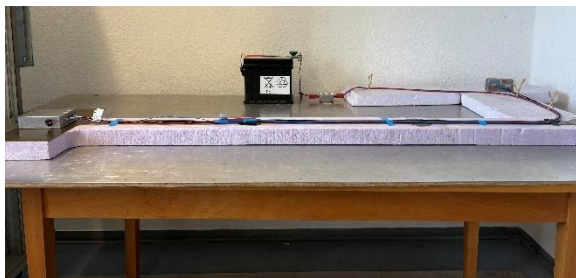
Abbildung 45 Beispiel ESD-Prüfaufbau mit Koppelplatte
