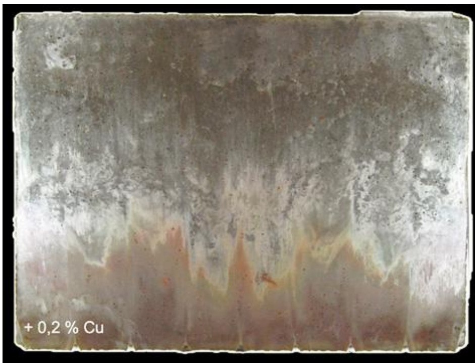
Bild 32 Plattenförmiges Bauteil mit um 0,2% erhöhtem Cu Anteil in der Legierung und nach Korrosionsschnelltests mit Kupfersulfat-Lösung
