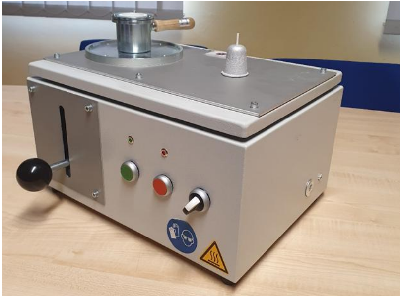
Bild 8 Meßeinrichtung zur Erfassung von Abkühlkurven
