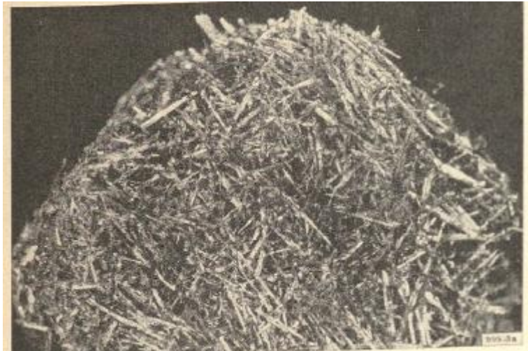
Bild 20 Filtrerrückstand Al-Mn-Fe Kristalle aus einer AlMn Legierung nach (24)
