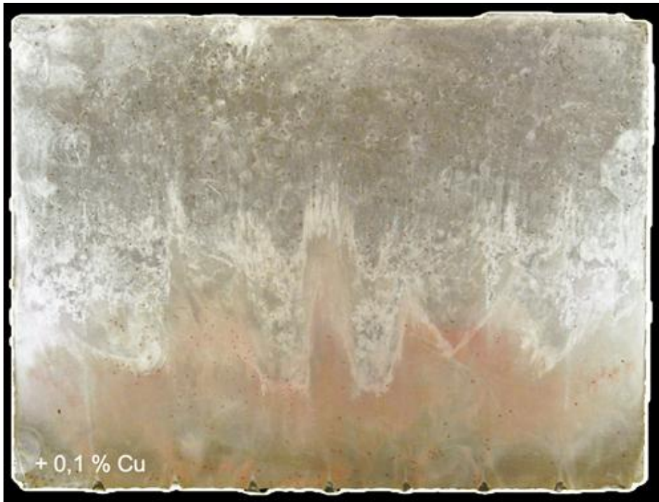
Bild 31 Plattenförmiges Bauteil mit um 0,1% erhöhtem Cu Anteil in der Legierung und nach Korrosionsschnelltests mit Kupfersulfat-Lösung
