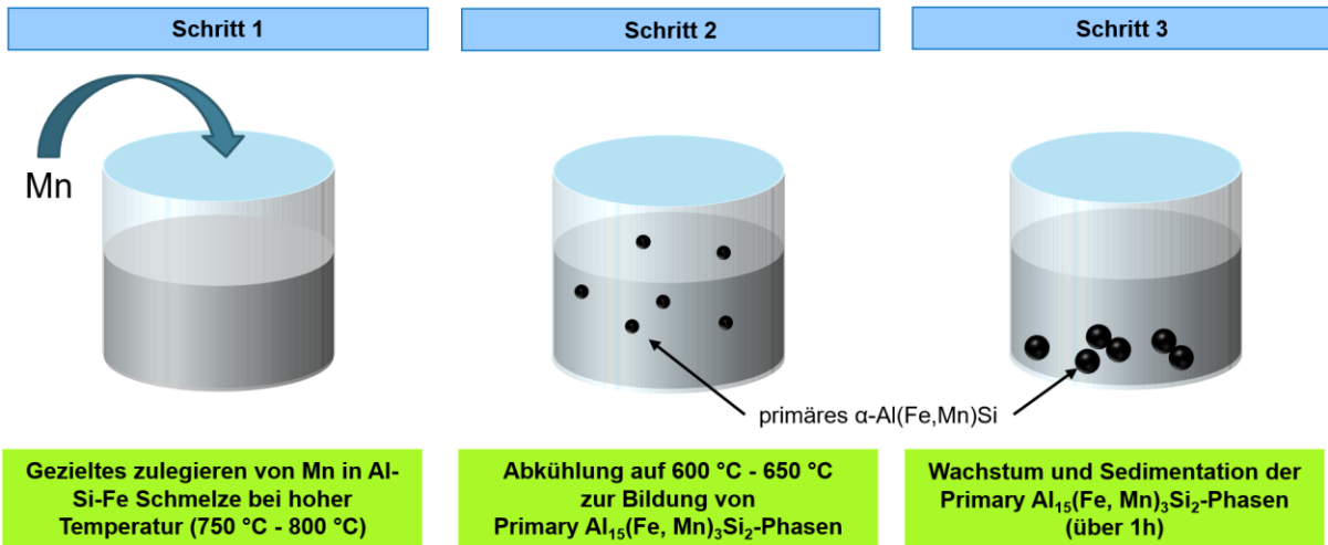
Bild 23 Verfahrensschritte zur Ausfällung von Fe-Mn-Phasen (gemeinsam mit Trimet Aluminium SE)
